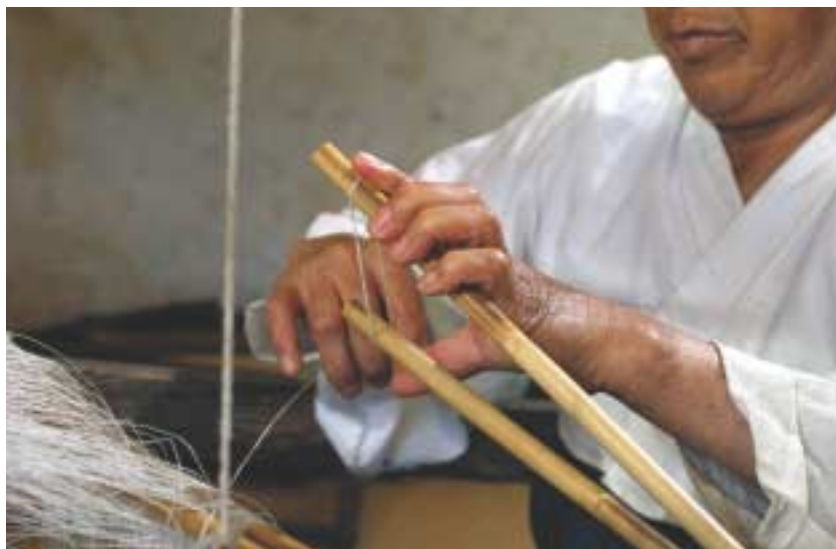
그림 196. 처음 잉앗줄을 잉앗대에 여러번 감는다
