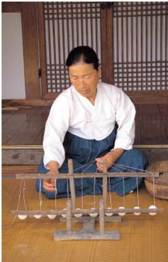
그림 95. 10개의 실뎡이가 다 끼워지면 10올의 실을 모아 잡아챈다. 10올을 한 모숨이라 한다
