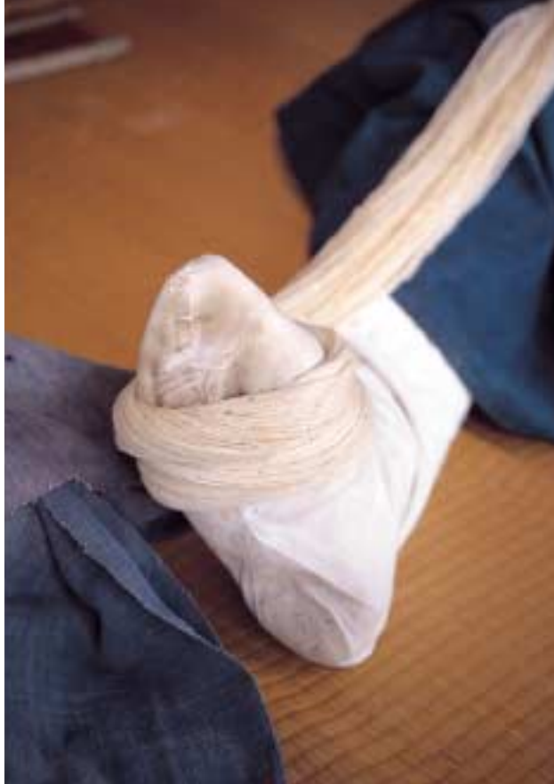
그림 126. 날실 사침부분을 작업자 앞으로 오게 하고 뒷부분은 발끝에 묶어 고정시킨다
