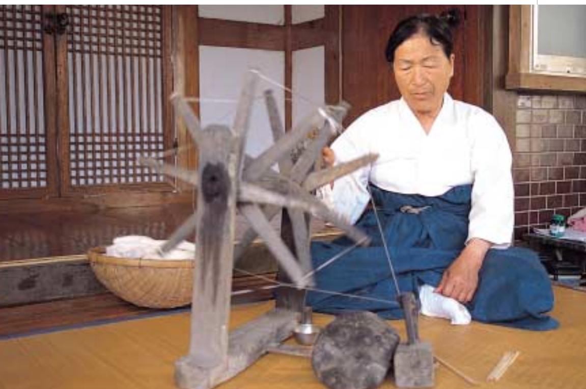
그림 79. 물레가 준비되면 잘 도는지 여러번 돌려가며 확인한다
