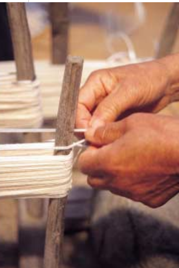
그림 112. 마지막 A까지 왕복이 끝나면 실을 끊어서 5올씩 잡아 A말쪽에 묶는다
