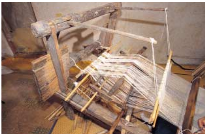
그림 223. 도투마리에 감겨진 날실이 다 풀어져 나오면 툇맞이가 드러난다
