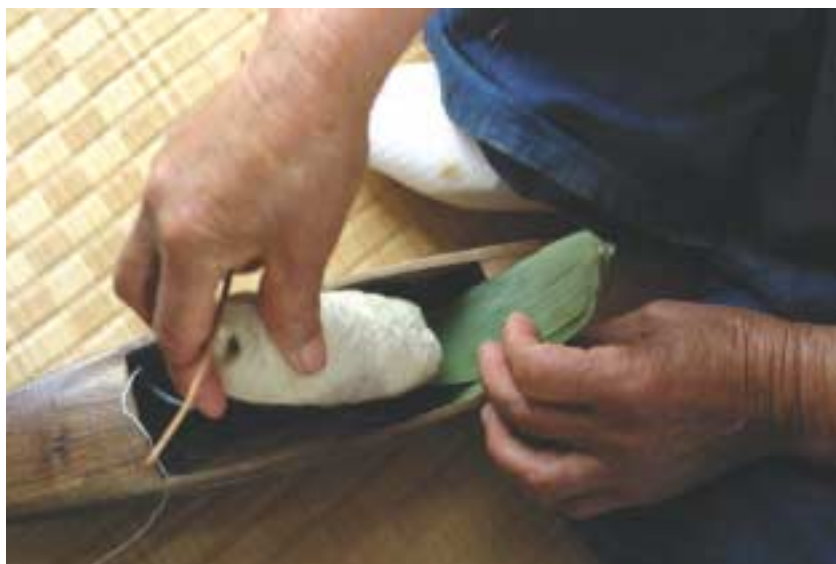
그림 207. 실끝을 북구멍 밖으로 빼내고 닻잎을 깔고 위사꾸리를 북안에 넣는다
