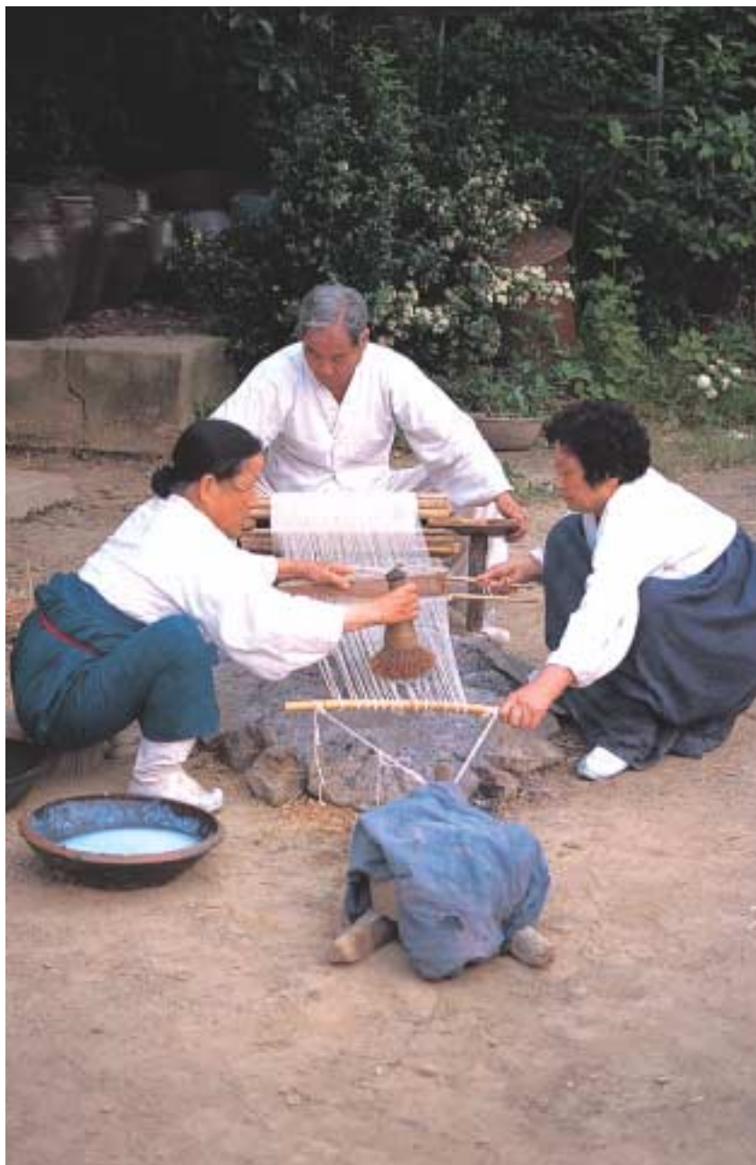
그림 162. 마지막 날실 끝은 톱잼이(죽봉)에 끼워 고싱개에 매고 날실의 끝까지 풀을 먹인다
