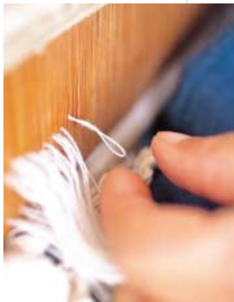
그림 133. 바디구멍에 끼워진 날실을 바디 앞쪽에서 손가락에 걸쳐 잡아 뺀다
