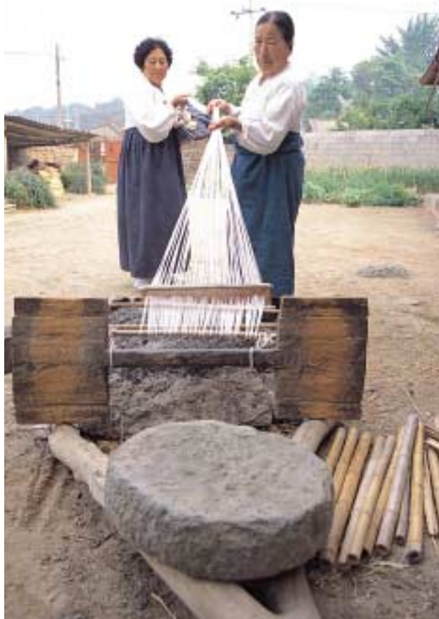
그림 152. 날실의 한쪽끝을 들고 땅에 끌리지 않도록 조 심하며 꼬싱개 쪽으로 옮긴다
