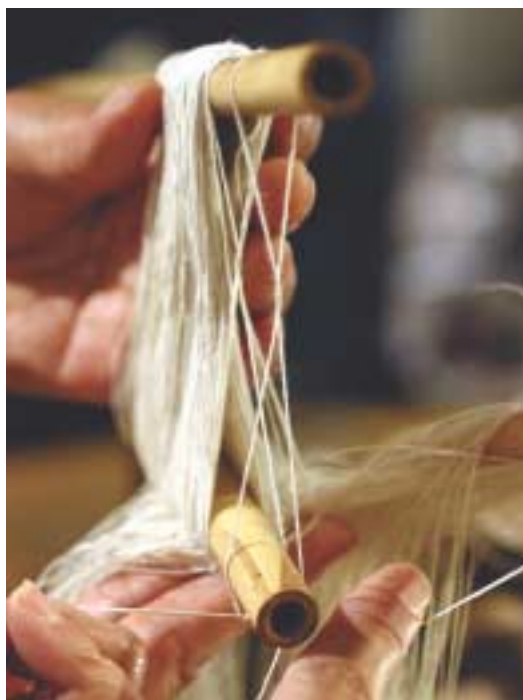
그림 198. 잉앗줄은 잉아울을 걸고 난 뒤 8자로 꼬아 위 잉앗대에 걸고 다시 아래 잉앗대 뒤로 걸린다
