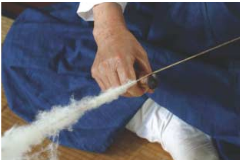
그림 61. 꼭두말로 활줄을 걸어 잡아당기며 진동을 일으켜 솜을 탄다
