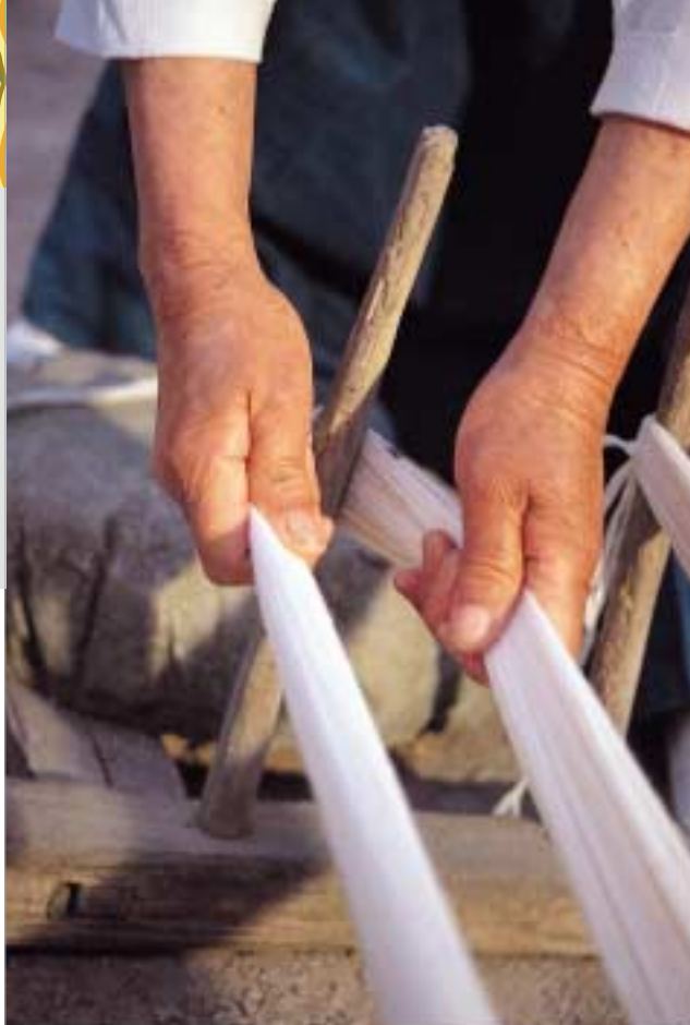
그림 114. 베날기가 끝나면 C중간말뚝의 날실부터 들어서 빼낸다
