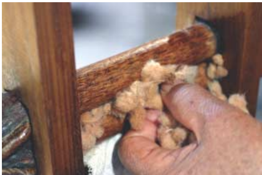
그림 51. 목화를 가락 사이에 집어 넣으면 씨는 앞으로 떨어진다
