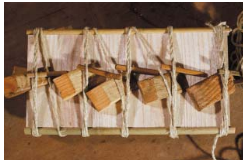
사진 130. 문판 탕개질 (썩기 박은 모습)
