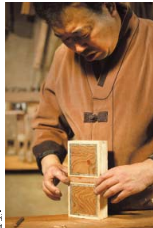
사진 112. 쥐벽칸의 알갱이와 알갱이 사이에 쇠목댄 모습
