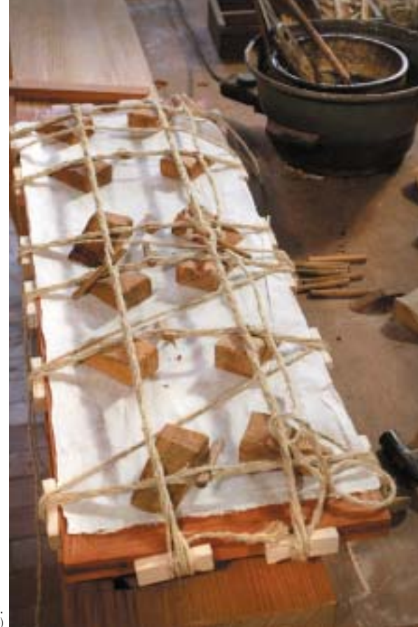
사진 129. 하단 탕개질 (썩기 박은 모습)
