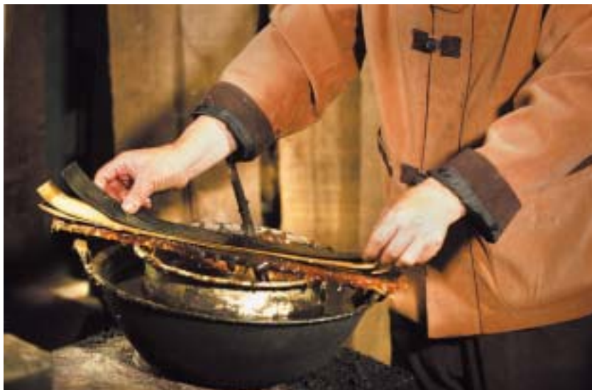
사진 95. 호장선만들기 (사진 94에 검은 호장선 붙이기)
