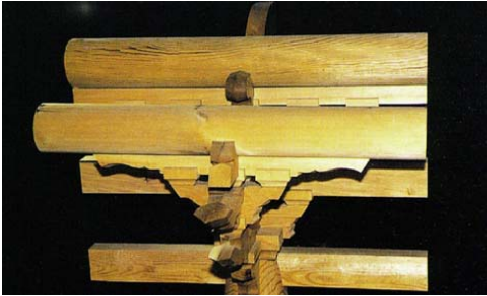
사진88. 주심출목도리 설치
