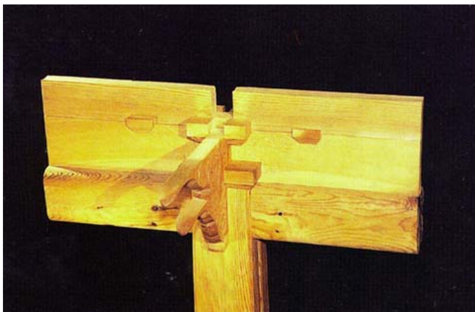
사진57. 장혀 설치
