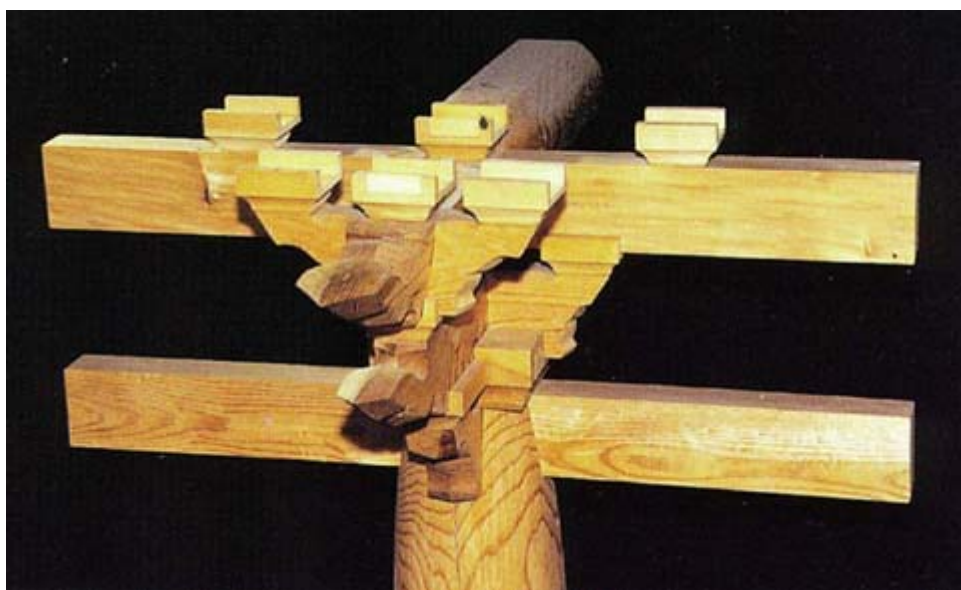
사진83. 대량 설치
