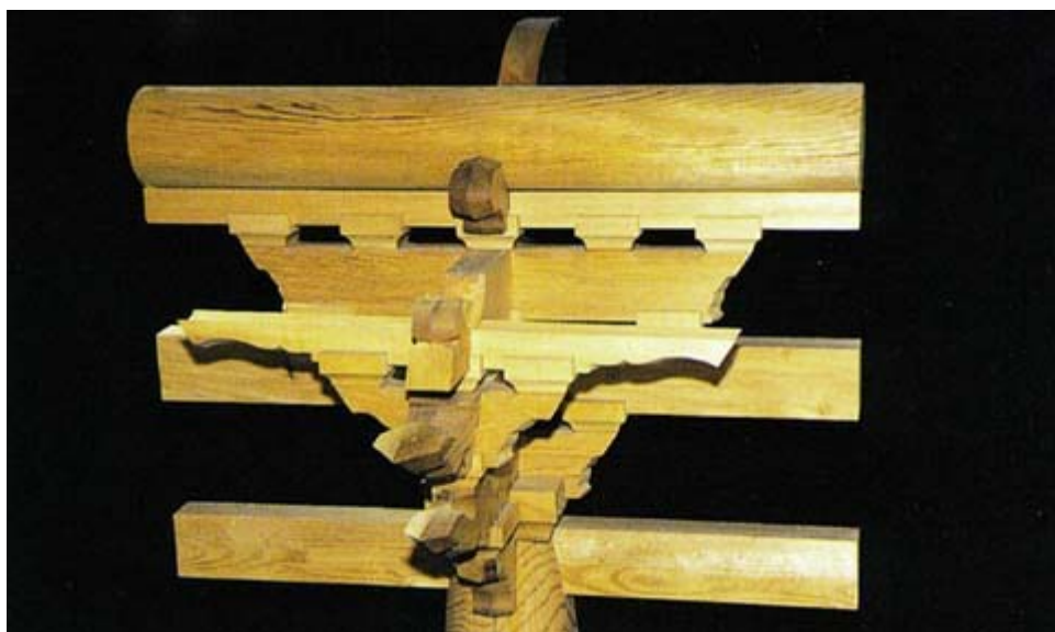
사진87. 주심도리 설치
