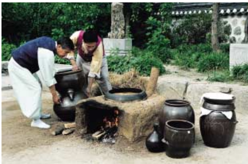
사진 120. 가마솥에 술덧을 다 넣었으면 그 위에 소줏고리를 얹는다
