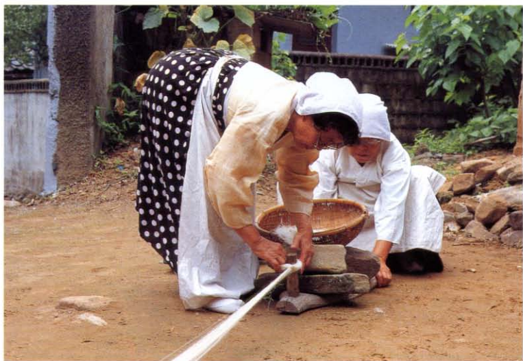
꼬싱개 위에 무거운 돌을 올리고 그 위에 소쿠리를 올린 다음 들말이 끌릴 정도로 힘껏 잡아당겨 꼬싱개의 말뚝부분에 묶는다.
