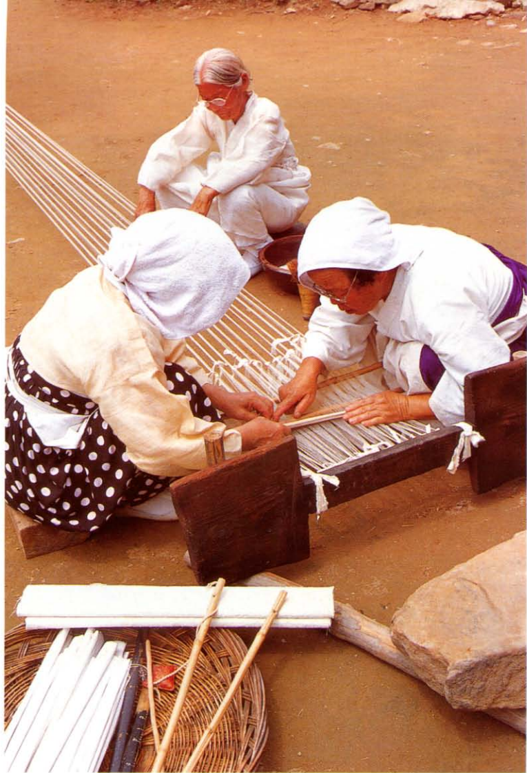
들말부터 꼬상개까지 팽팽하게 당긴 후 바디에 날실이 잘 꿰어있는지 확인한다.
