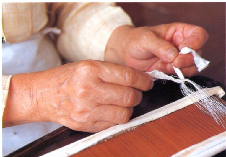
끈으로 묶어둔 한새를 풀어 2올씩 바디구멍에 꿰 다음 바늘에 한 새 80올을 모두 꿰면 풀어두었던 끈으로 다시 묶는다.
