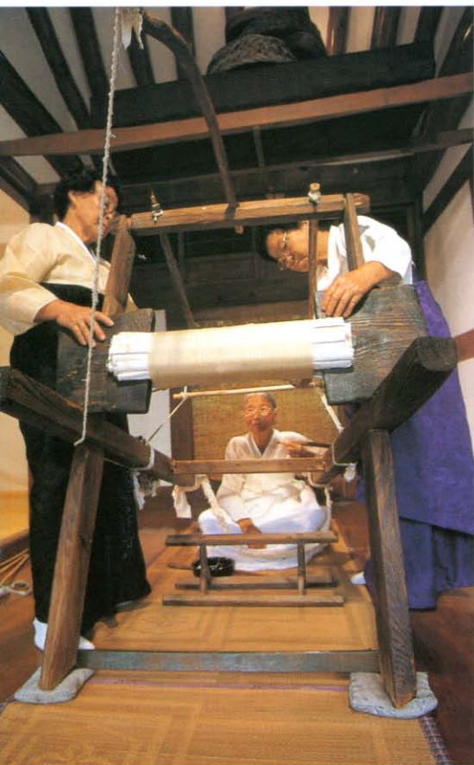
보유자가 베틀의 가로목과 앞을개 사이의 바닥에 앉고, 두 동서는 도투마리에서 바디를 앞쪽으로 당긴다.
