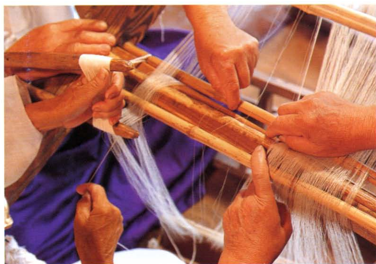
보유자는 왼손에 잉아틀을 쥐고 두 동서가 사침대를 지나 바디에 꿰어진 잉아울과 사울을 갈라 주면, 오른손으로 잉앗대에 실고리를 만든다.
