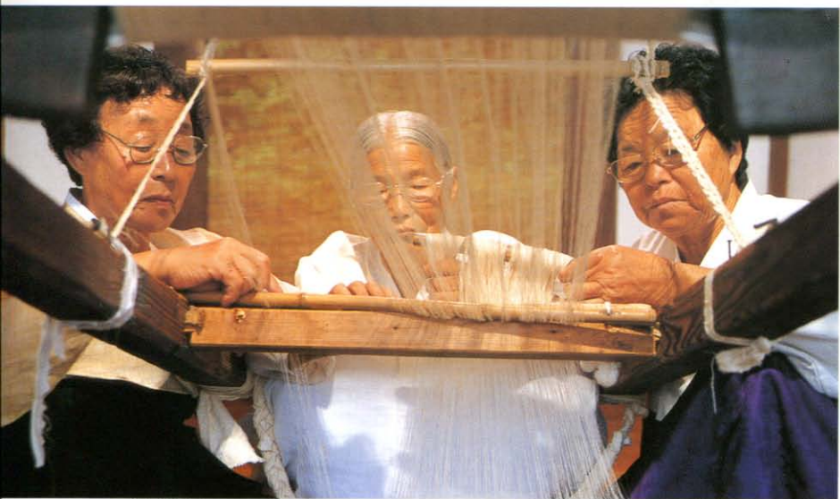
(위) 잉아올과 사올을 일일이 가르면서 잉아를 건다. (아래) 열넉새 짜리 잉아를 빠짐없이 잉앗대에 걸려면 한두 시간이 훌쩍 지나간다.
