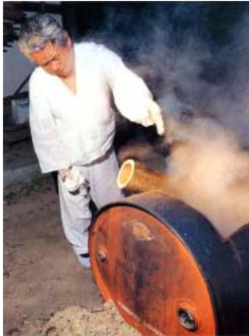
서현환<1> 대나무 삶기 대나무의 기름(진)을 빼기 위해서 통에 넣고 3일 정도 삶는다. 이렇게 하면 대나무 속의 삭아진 기름이 밖으로 빠져 나오는데, 대나무의 열이 식기 전에 겉에 묻은 끈끈한 기름을 닦고 윤이 날 정도로 문지른다.
