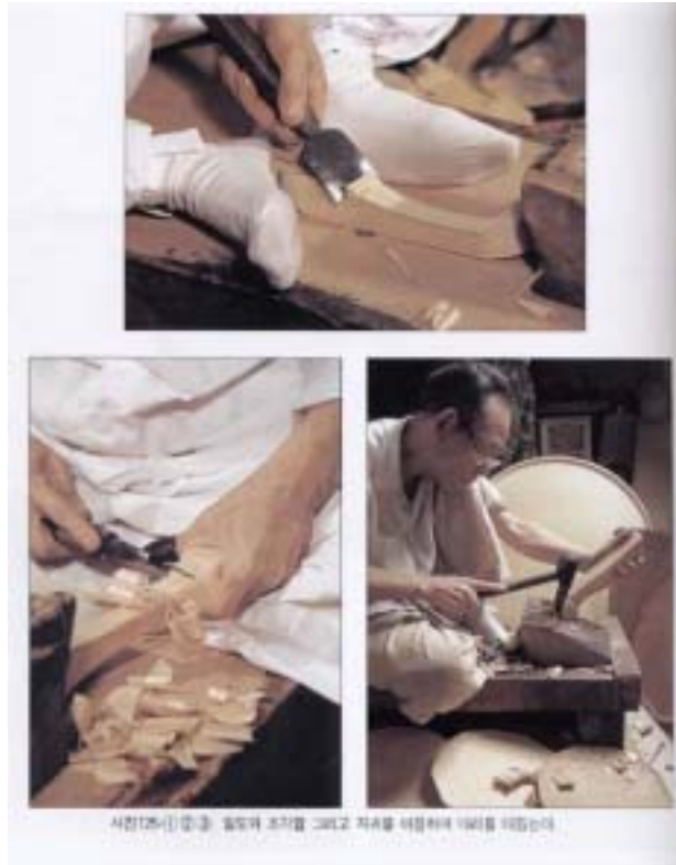
사진125-①②③. 밀도와 조각칼 그리고 자귀를 이용하여 다리를 다듬는다.
