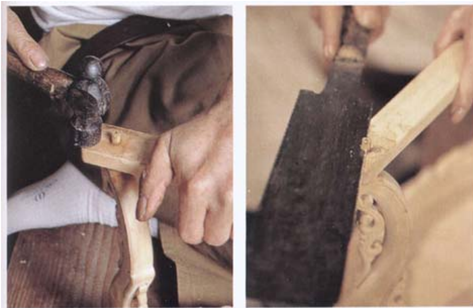
사진114-①②. 다리 끝에 죽대를 놓고 싸리뭇으로 박아주며 톱으로 남은 부분은 잘라준다.
