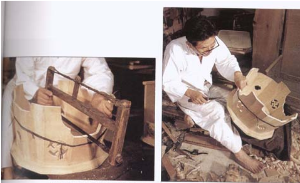
사진101-①②. 아교풀이 건조된 후 톱으로 보상무늬의 창을 만든 후 조각칼로 다듬는다
