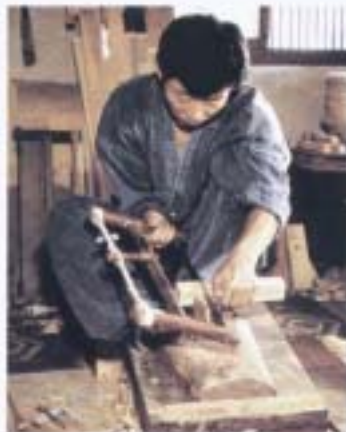
사진71-①(조각칼) 툼과 자귀 그리고 조각칼로 다리를 다듬고 사포질로 끝마무리를 한다.
