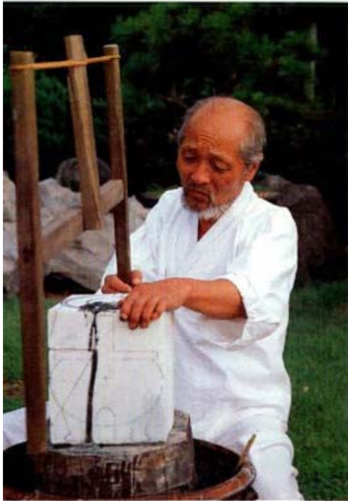
사진56. 향로본체 기둥부분 만들기 향로본체 기둥부분을 제외한 부분을 큰내릴톱으로 자른다
