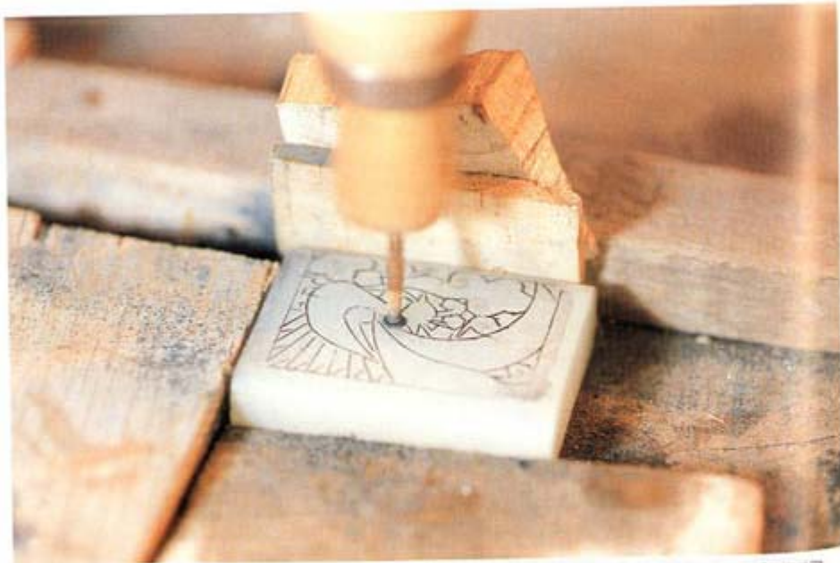
사진134. 향집노리개의 밑그림을 조각하기 위해서 작은내릴톱의 철사를 넣을 수 있는 구멍을 활비 뚫는다.
