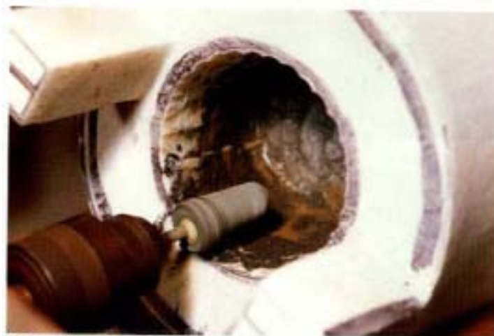
사진 72. 내부 거친부분 갈기 손갈이틀에 추지석 연마공이를 부착하고 수용성 연마제를 주입하면서 거친 옆면을 갈아낸다.
