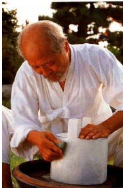
사진63. 향로본체외형(원형)다듬기 향로본체외형(원형)을 갈이틀로 갈아낸 다음 솥돌로 다시 다듬는다.
