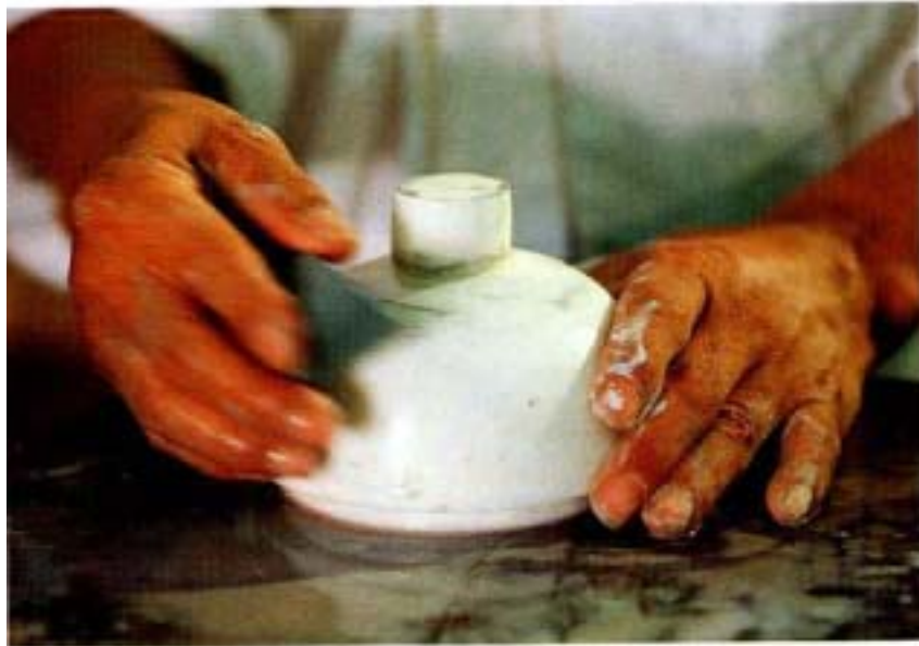
사진88. 뚜껑 손잡이 만들기 원통형이었던 뚜껑의 겉면을 같이틀로 둥글게 갈아내고 숫돌로 더 부드럽게 갈아낸다.
