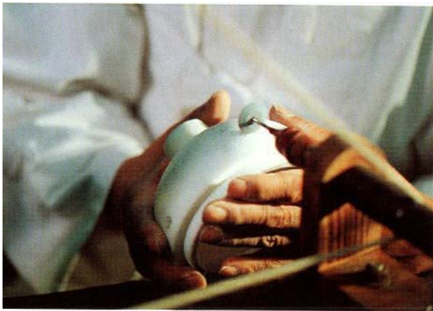
사진96. 조각하기 물레에 탄화규소 열전형날을 부착하여 문양의 선에 따라 조각한다.
