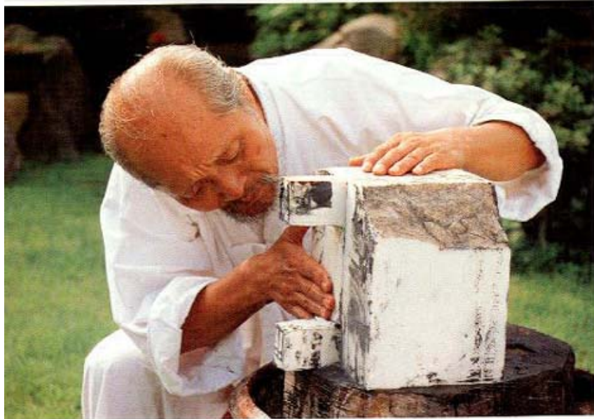
사진60. 향로본체외형(원형)다듬기 향로본체외형(원형)을 그리기 위해 숫돌로 면을 곱게 다듬기전에 표면을 살핀다.
