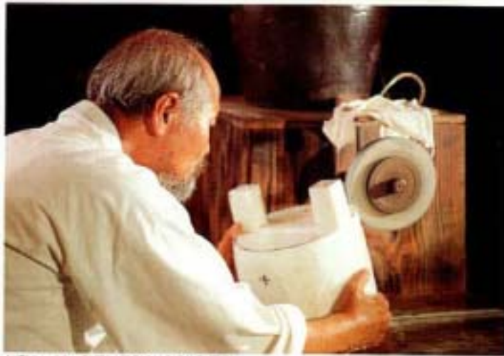
사진61. 62. 향로본체외형(원형)다듬기 향로본체외형(원형)을 직경 195mm로 그리고 나서 거칠고 각진 부분은 갈이틀에 대고 갈아낸다.
