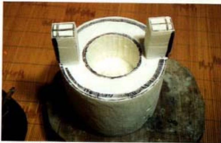
사진69,70. 향로본체 내부 파내기 활비비 금강관상을 이용하여 구멍을 낸다. 1번 구멍의 깊이는 약15mm씩 파들어 간다. 1차 파낸 다음 계속적으로 필요한 깊이 만큼 파들어 간다.
