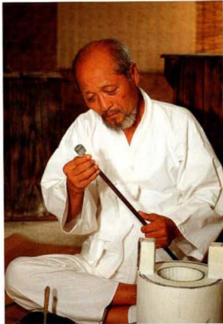
사진71. 내부 거친부분 갈기 속을 파낸 옥향로 본체 내부를 추지석 연마공이와 활비비를 이용해서 갈아내기 위해 공이를 확인한다.
