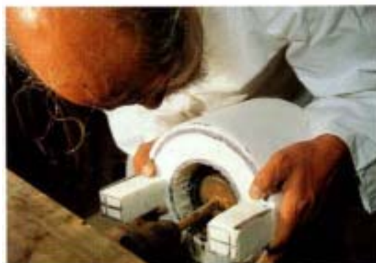
사진 73, 74. 내부 거친부분 갈기 손갈이틀에 또다른 추지석 연마공이나 쇠공이를 부착하여 수용성 연마제 를 주입하면서 옆면과 바닥부분을 갈아낸다.
