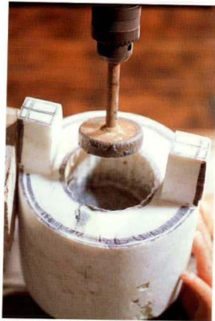
사진75. 내부 거친부분 갈기 손갈이틀에 부착한 쇠공이를 삽입하는 모습
