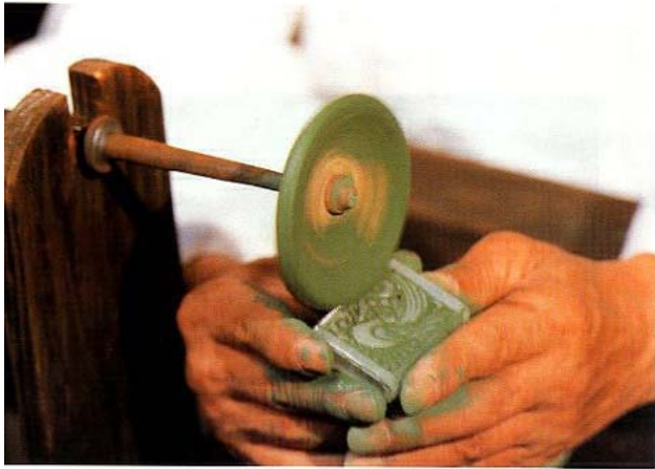
사진144. 발로 광택틀을 작동시켜서 향집노리개의 표면에 문지르면서 광을 낸다.
