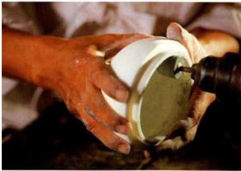
사진90. 뚜껑 내부 파내고 다듬기 활비비 금강관상을 필요한 깊이 만큼 파내고 손칼이들을 이용해서 뚜껑 내 부를 갈고 다듬는다.
