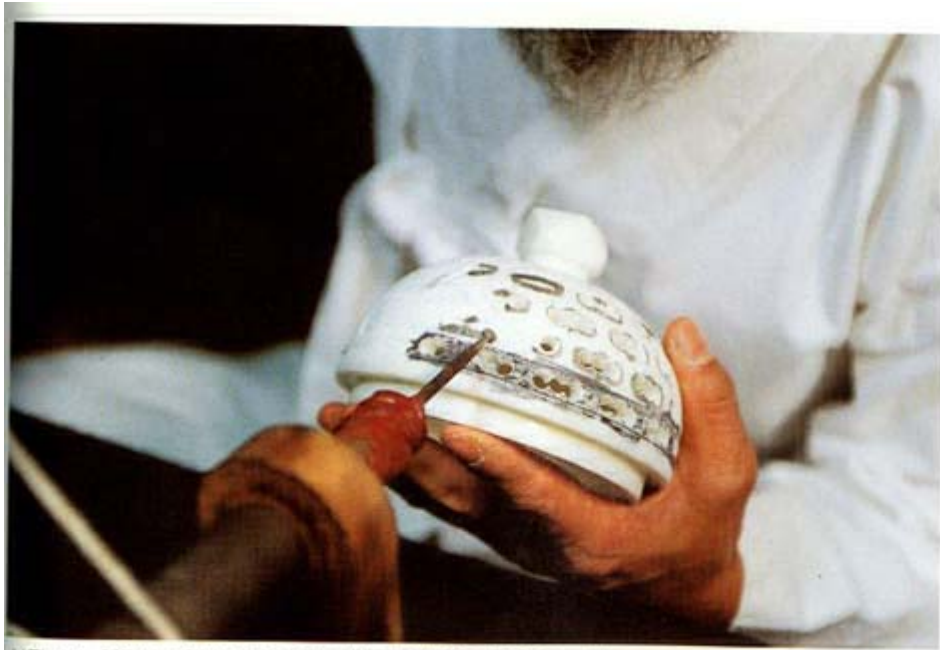
사진105. 뚜껑에 그려넣은 밑그림에 따라 구멍을 뚫고 조각하는 모습
