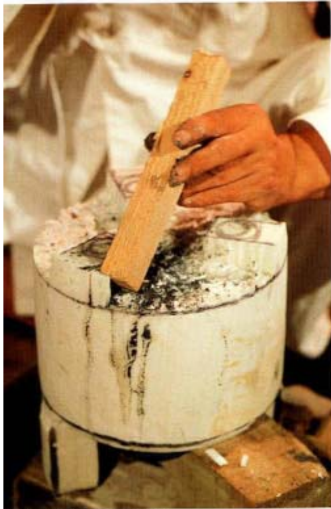
사진78. 향로본체 다리부분 만들기 활비비 금강관상을 이용하여 파낸 부분을 제거한다.
