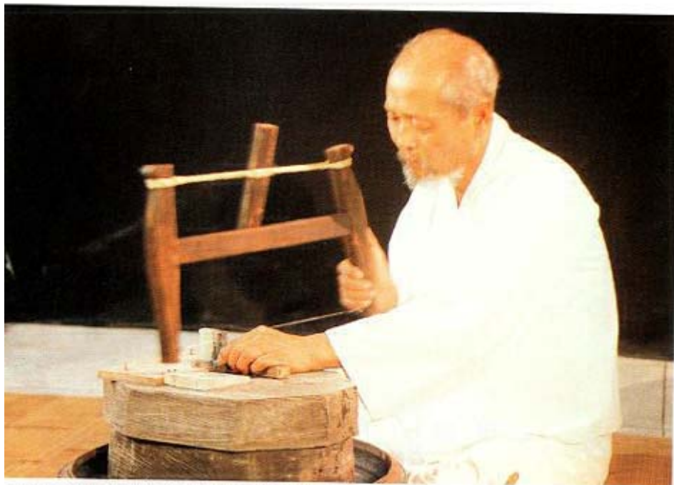
사진119. 먹상감을 한 크기대로 잘라내는 모습
