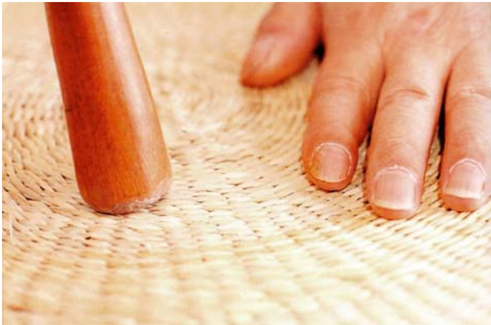
사진39-①. 방석과 앞면의 뒷면을 방망이로 쳐주면서 벌어진 공간이나 간격을 밀착시킨다.
