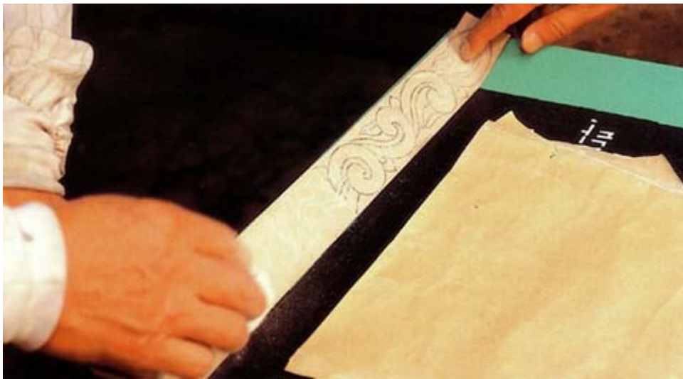
사진114. 바늘로 구멍을 낸 도안 종이를 대고, 호분으로 쳐서 밑그림을 그린다.
