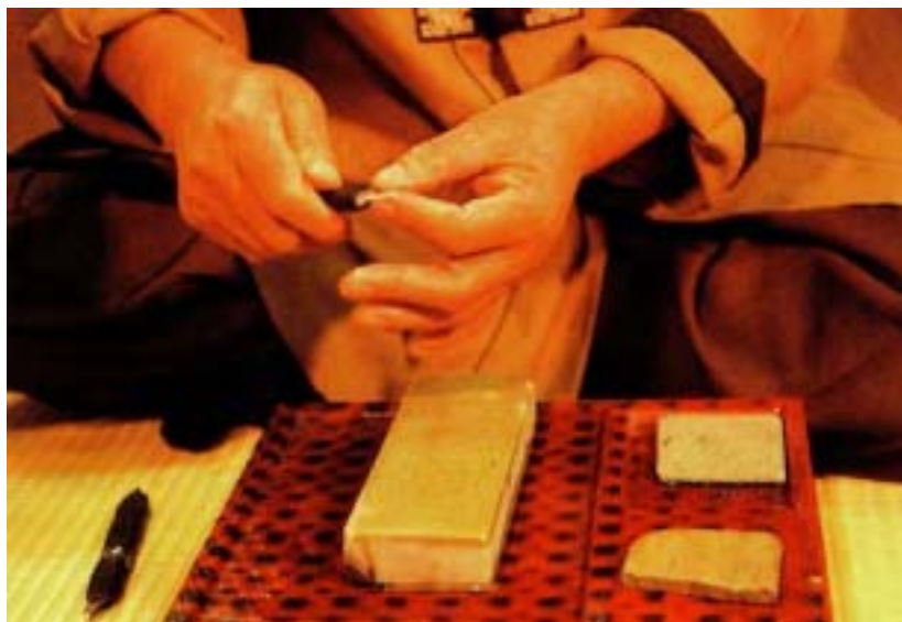
사진25. 마무리칼은 갈아서 손가락으로 날을 확인한다.
