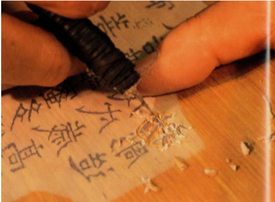
사진62. 반서각은 왼손 엄지손가락으로 밀어준다.
