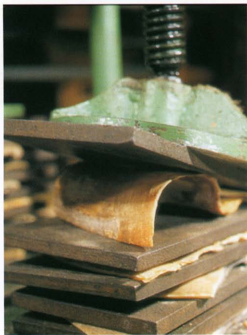
(위) 구운 쇠뿔을 열어 편 후 밟아서 평평하게 만든다. (아래) 쇠뿔판을 누름쇠판 사이에 끼워 압착기로 식을 때까지 조여 둔다.
