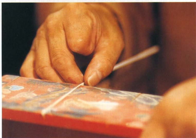
(왼쪽)우쿨 계선(쇠뼈오리)을 박 기 위한 흠파기(계선톱 사용). (아래)계선톱 속에 부레풀칠을 해놓고 우쿨 계선(쇠뼈오리)을 끼워 넣는다.
