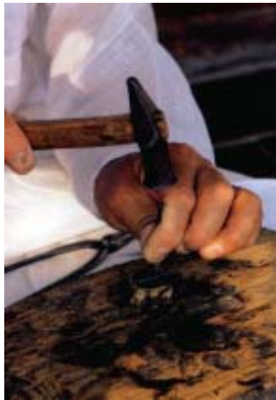
사진58. 정은 자침에 중심 구멍을 내거나 날개를 잘라낼 때 사용한다.
