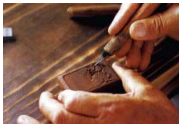
사진187, 188. 뚜껑의 표면에 무늬를 조각한다.
