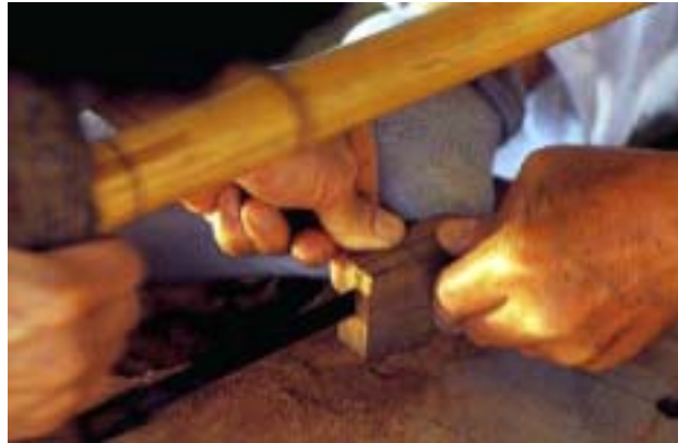
사진179, 180. 직사각형으로 자른 나무를 몸체와 뚜껑으로 나눈다.
