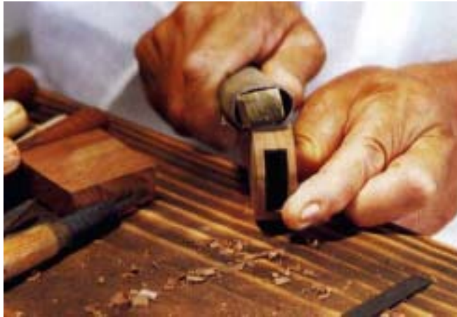
사진174. 사포를 이용하여 매끈하게 다듬는다.
